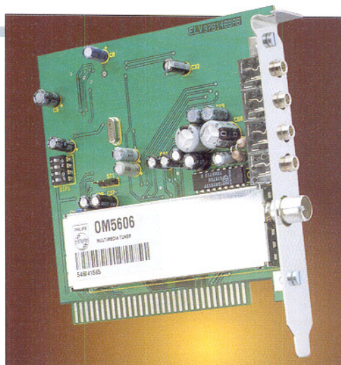
◀ ELV-PC-Multimedia-Radio mit Philips UM 5604-Multi- media-FM-Tuner, R(B)DS-Decoder, 5-Band-Equalizer und 2 x 6W-HiFi- Verstärker Seite 60
