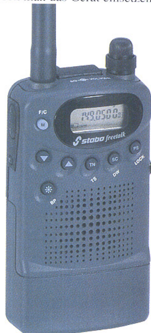
Bild 6: Ein kompakter Vertreter der FreeNet-Garde: das stabo Freetalk - Funken auf 2 m ohne Anmeldung und Gebühren. Foto: stabo
