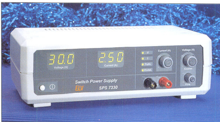
▲ 30V/5A-Labor-Schaltnetzteil mit hohem Wirkungsgrad und geringer Verlustleistung Seite 40
