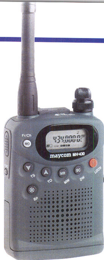
Bild 8: Mit 10 Kanalspeichern und komfortabler gleichzeitiger Überwachung von zwei Kanälen, CTCSS und abschaltbarer Klingelfunktion ist das MH-430 ein Vertreter der neuesten LPD-Generation. Foto: Albrecht
