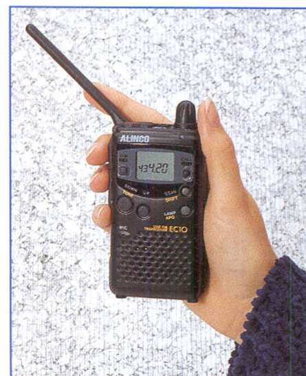
Bild 1: Seit 1995 erlaubt: CB-Funk auf 433 MHz. Inzwischen finden die LPD-Minifunkgeräte eine weite Verbreitung auch im kommerziellen Bereich.
